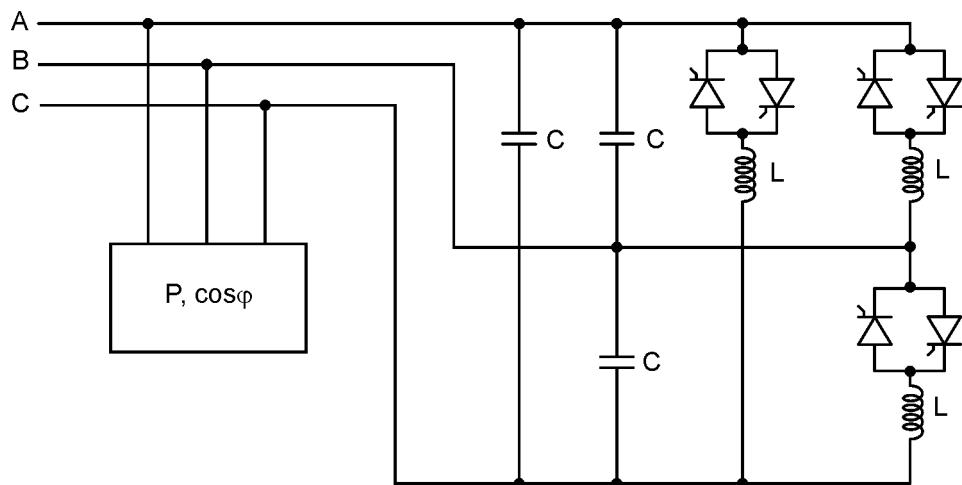
2. Исправљач са слике прикључен је на мрежу, напона  $3 \times 380\text{ V}$ ,  $50\text{ Hz}$ . Ефективна вредност струје примара трансформатора је  $20\text{ A}$ . На отпорнику  $R$  измерена је снага  $P = 7.21\text{ kW}$ , а индуктивност пригушнице  $L$  је доволно велика да се може занемарити наизменична компонента струје оптерећења. Одредити угао управљања тиристорима.
